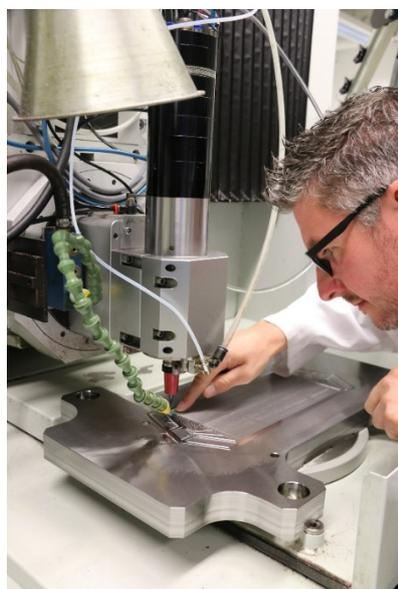
**Abb. 2 Udo Eckert, Gruppenleiter Mikrosystemfertigung, aus der Abteilung Funktionsoberflächen/Mikrofertigung am Fraunhofer IWU prüft im Mikrobearbeitungszentrum des IWU die Finish-Bearbeitung eines gefrästen Werkzeugs für den Einsatz bei der Bipolarplattenfertigung für Brennstoffzellen.**
